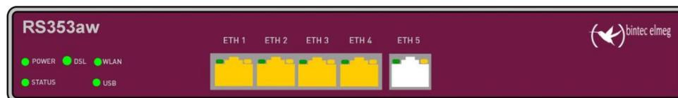
Abb. 9: Anordnung der LEDs **bintec RS353aw**
